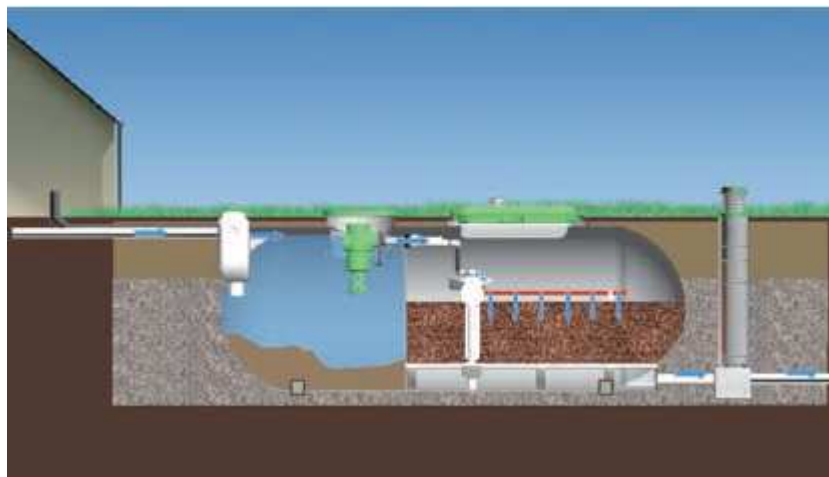
Schéma de principe d'une filière compacte (EpurFlo)
